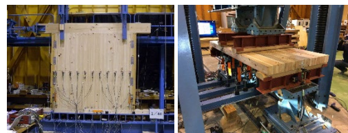
NLT壁の耐力試験(左)とNLT床版の曲げ試験(右) - いずれも栃木県林業センターにて実施
