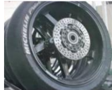
図2. アルミ合金上に鉄クロム合金めっきされたオートバイ用ブレーキディスク（企業との共同研究成果）
