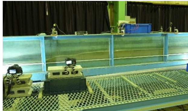
図1 土石流の水路実験
