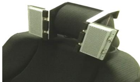
図1 耳側音響システムプロトタイプ
