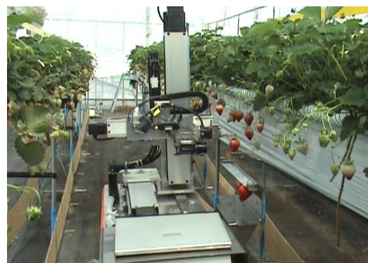
図1 イチゴ収穫ロボットの実証試験
