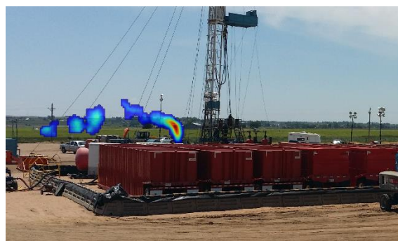
(左図) 石油の掘削場のメタンガス漏れを可視化。
