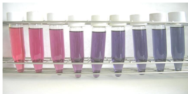
図1 熱応答性高分子を被覆した金ナノ粒子を用いるシステムの色彩計測
