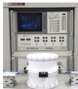
3Dプリンタ製材料評価用共振器とその評価結果
